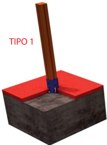
FIJACION A SOLERA DE HORMIGON
