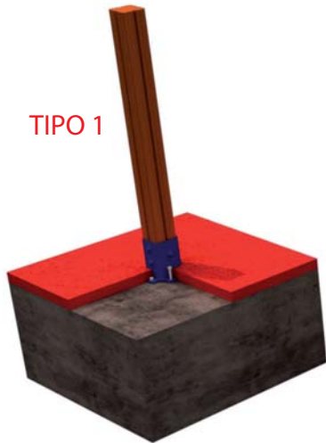
FIJACION A SOLERA DE HORMIGON
