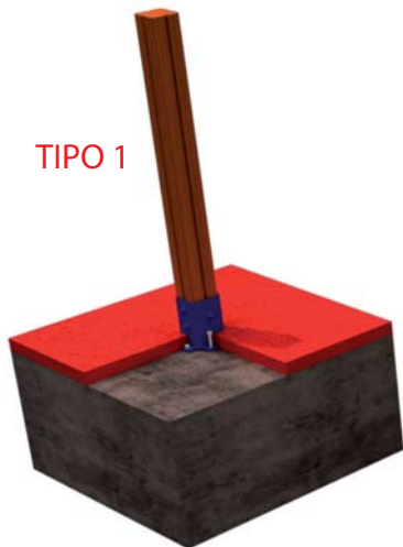
FIJACION A SOLERA DE HORMIGON
