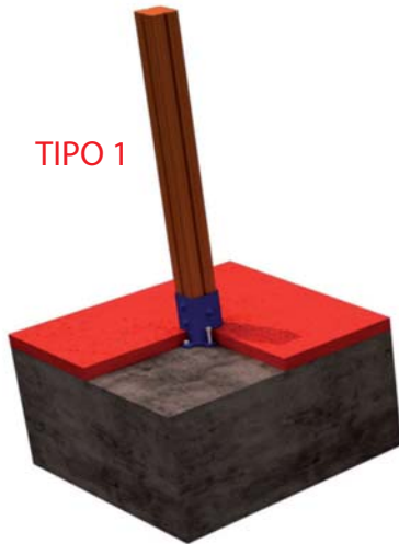
FIJACION A SOLERA DE HORMIGON
