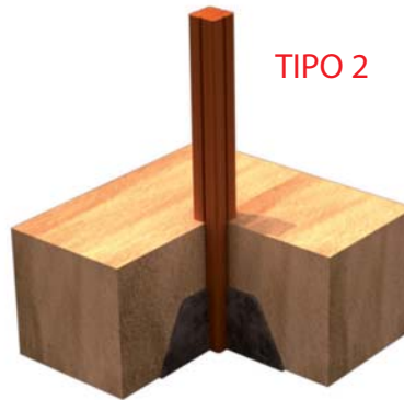
FIJACION A SUELO BLANDO
