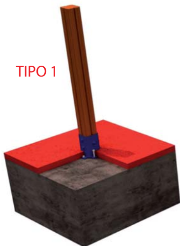
FIJACION A SOLERA DE HORMIGON
