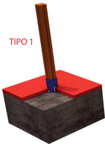
FIJACION A SOLERA DE HORMIGON
