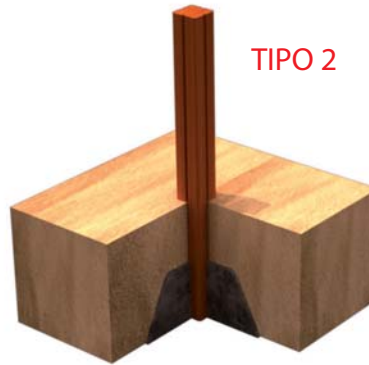
FIJACION A SUELO BLANDO
