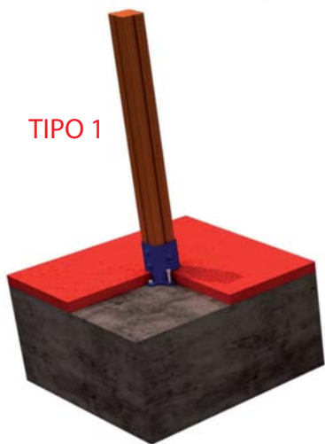
FIJACION A SOLERA DE HORMIGON
