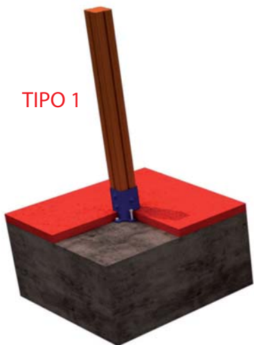
FIJACION A SOLERA DE HORMIGON
