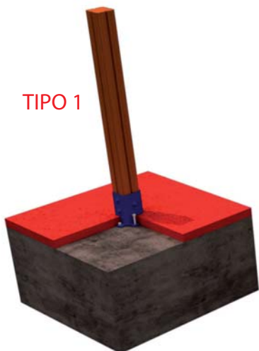
FIJACION A SOLERA DE HORMIGON
