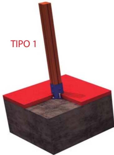
FIJACION A SOLERA DE HORMIGON
