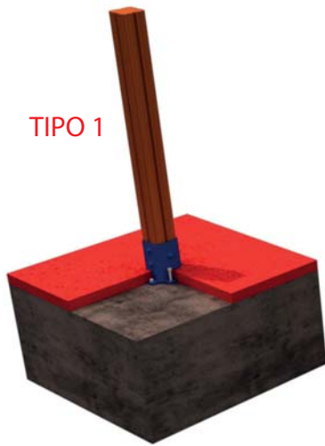
FIJACION A SOLERA DE HORMIGON
