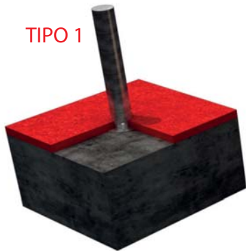
FIJACION A SOLERA DE HORMIGON
