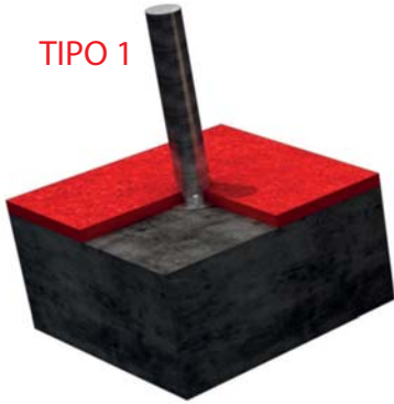
FIJACION A SOLERA DE HORMIGON
