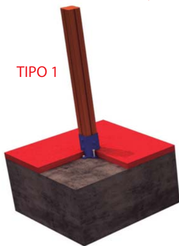
FIJACION A SOLERA DE HORMIGON
