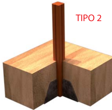
FIJACION A SUELO BLANDO
