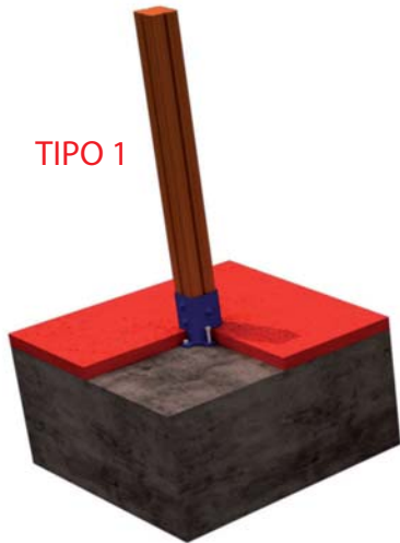
FIJACION A SOLERA DE HORMIGON
