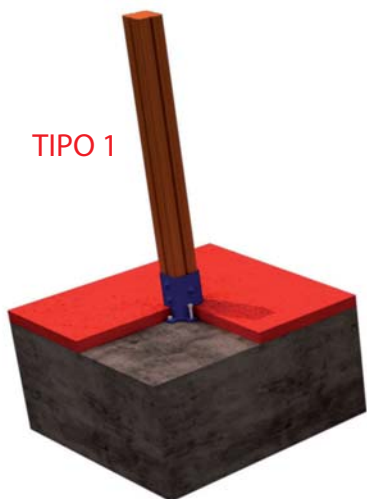
FIJACION A SOLERA DE HORMIGON
