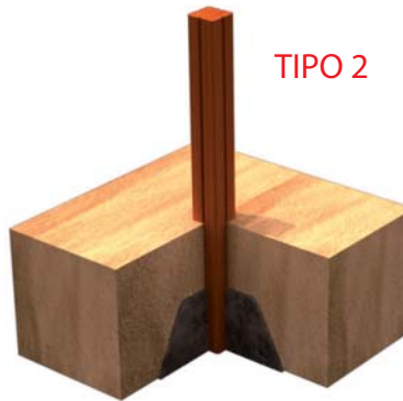
FIJACION A SUELO BLANDO
