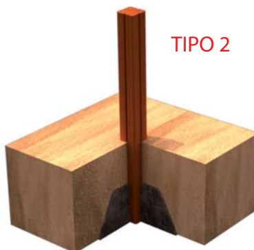
FIJACION A SUELO BLANDO
