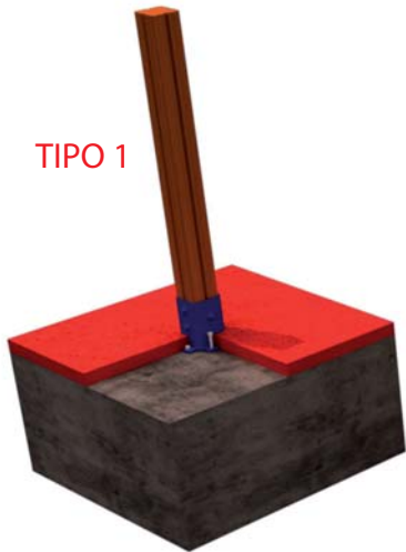
FIJACION A SOLERA DE HORMIGON
