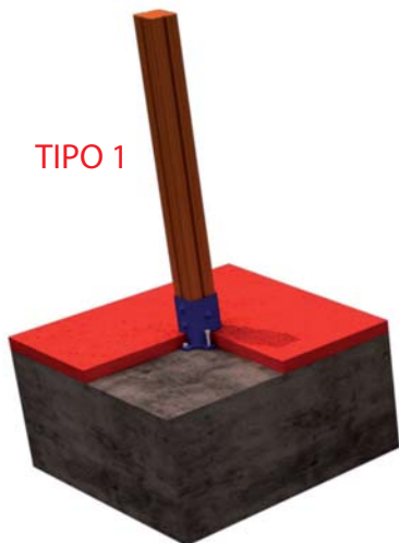
FIJACION A SOLERA DE HORMIGON
