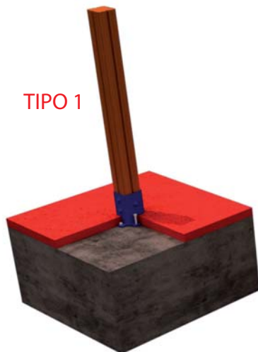
FIJACION A SOLERA DE HORMIGON
