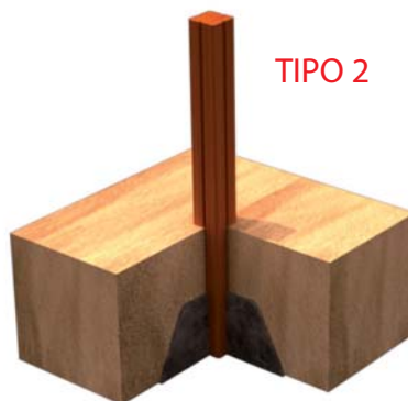
FIJACION A SUELO BLANDO
