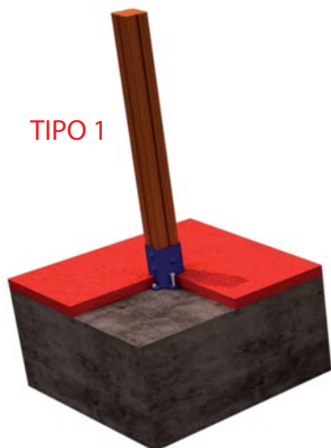
FIJACION A SOLERA DE HORMIGON
