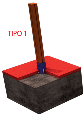
FIJACION A SOLERA DE HORMIGON
