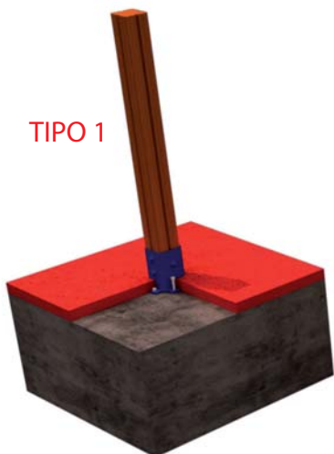
FIJACION A SOLERA DE HORMIGON
