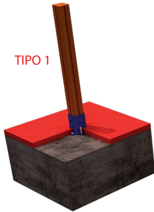
FIJACION A SOLERA DE HORMIGON
