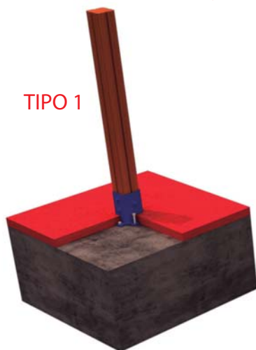
FIJACION A SOLERA DE HORMIGON
