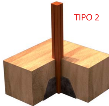
FIJACION A SUELO BLANDO
