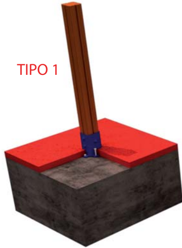
FIJACION A SOLERA DE HORMIGON
