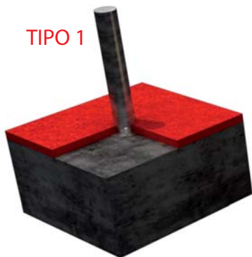
FIJACION A SOLERA DE HORMIGON
