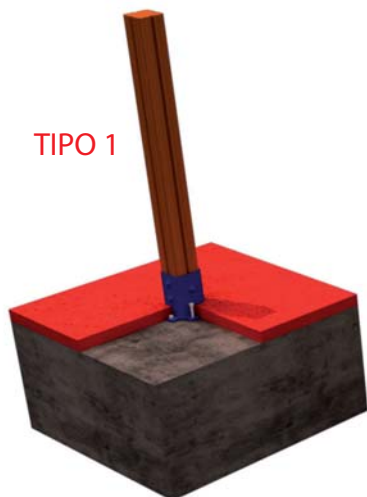
FIJACION A SOLERA DE HORMIGON
