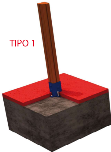
FIJACION A SOLERA DE HORMIGON
