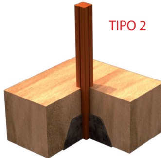
FIJACION A SUELO BLANDO
