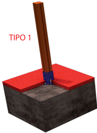
FIJACION A SOLERA DE HORMIGON
