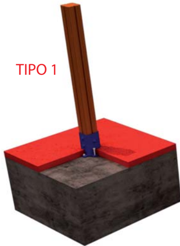
FIJACION A SOLERA DE HORMIGON
