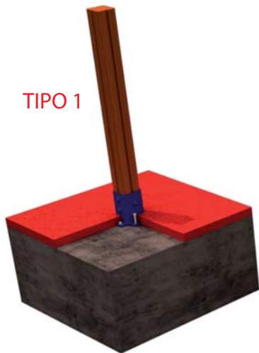
FIJACION A SOLERA DE HORMIGON
