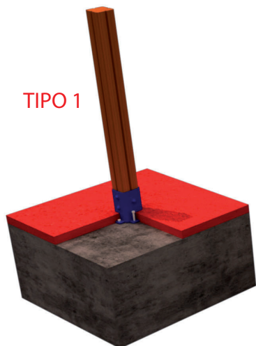
FIJACION A SOLERA DE HORMIGON
