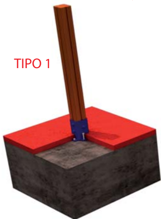
FIJACION A SOLERA DE HORMIGON
