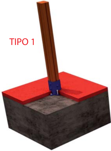
FIJACION A SOLERA DE HORMIGON
