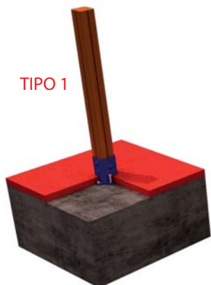
FIJACION A SOLERA DE HORMIGON
