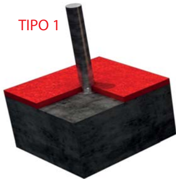
FIJACION A SOLERA DE HORMIGON
