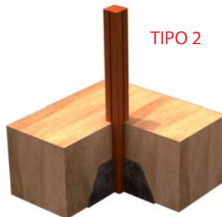
FIJACION A SUELO BLANDO
