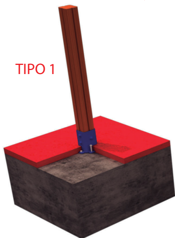
FIJACION A SOLERA DE HORMIGON
