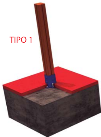
FIJACION A SOLERA DE HORMIGON
