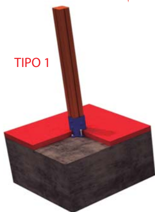
FIJACION A SOLERA DE HORMIGON
