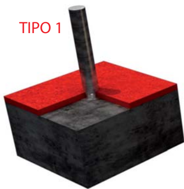
FIJACION A SOLERA DE HORMIGON
