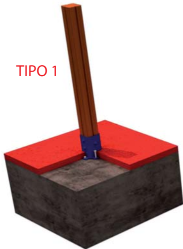
FIJACION A SOLERA DE HORMIGON
