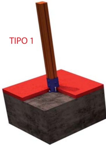
FIJACION A SOLERA DE HORMIGON
